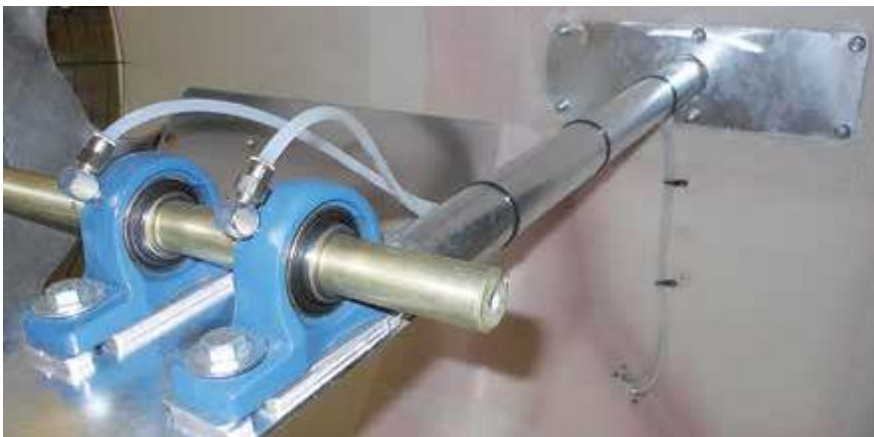
Photo 4 : Un système de lubrification à distance est conçu pour gagner du temps et faciliter l’entretien.
